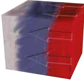
Şekil 1: AQUAFIX'in beton içerisine nüfuz ederek su yalıtımı sağlaması
